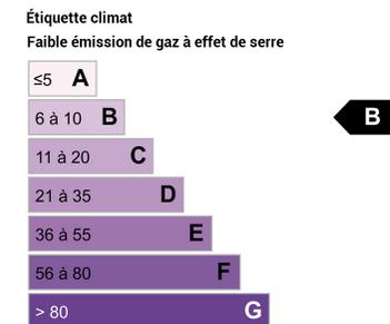
Les unités de mesure sont exprimées en kg équivalent CO2 par mètre carré et par an
