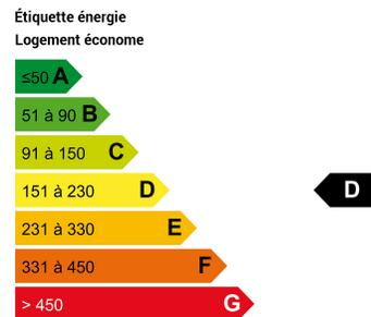
Les unités de mesure sont exprimées en kWh d'énergie primaire par mètre carré et par an
